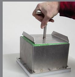
Con el émbolo del Dispositivo de Corte de Gel, empuja los cuadrados de gel a través del conjunto de cuchillas.
