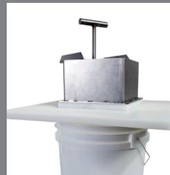
Configura el Dispositivo de Corte de Gel en la Tabla de Cortar colocada sobre un cubo o contenedor de almacenamiento.
